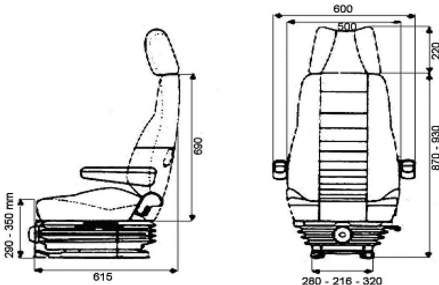
KAB 414 est un siège à suspension mécanique ayant une course de suspension de 100 mm, d'un réglage du poids du conducteur entre 50 à 120 kg et une inclinaison d'assise et support lombaire.
