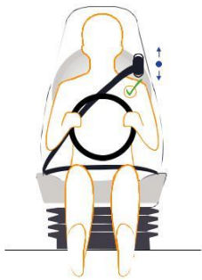
Réglage de la hauteur de la ceinture de sécurité 60 mm Belt height adjustment 60 mm
