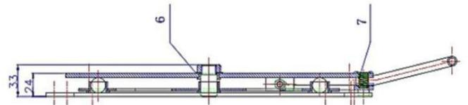
*La platine tournante CH-PDR 150655* donne à l'opérateur la capacité et la liberté de déplacer à 360° qui comprend aussi une poignée pour le relais rapide et plusieurs trous pour le montage qui convient à une grande variété d'application. Cette base a plus de 40 positions de verrouillage.
